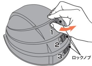
ロックノブの端部に親指を掛け、ロックノブを水平方向に手前へ引き出せば解除できます。
